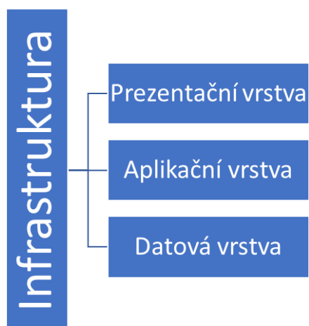
Obrázek 6: 3 vrstvá softwarová architektura
