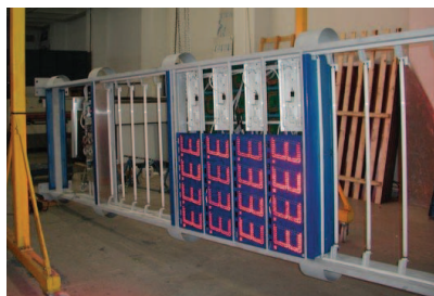
Obrázek 2.8: Použití LED panelů s osazením ve tvaru osmičky
