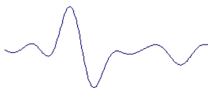
Obr. 11 Mrknutí filtr 0-8Hz
