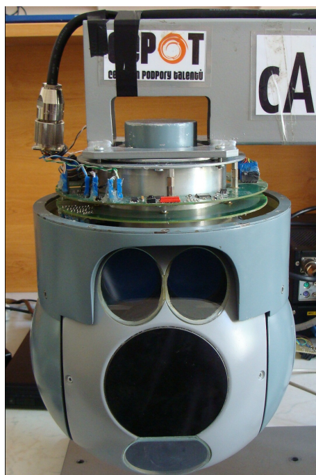
Obrázek A.3: Detail stabilizované základny.
