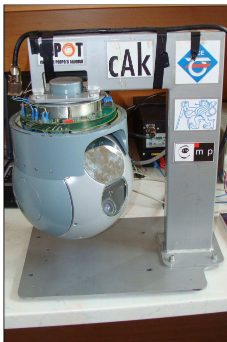
Obrázek A.2: Stabilizovaná základna uchycená k podstavci.
