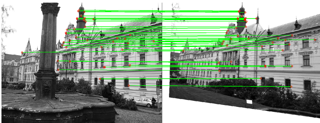
Obrázek 11. Příklad výsledku třetí fáze vyhledávání. Nalezená transformace mezi dvěma fotografiemi z předchozího obrázku. Vlevo obrázek dotazu a vpravo obrázek z databáze transformovaný do úhlu pohledu dotazu. Zelené úsečky spojují páry korespondencí. Nalezená homografie je podporována 41 korespondencemi.
