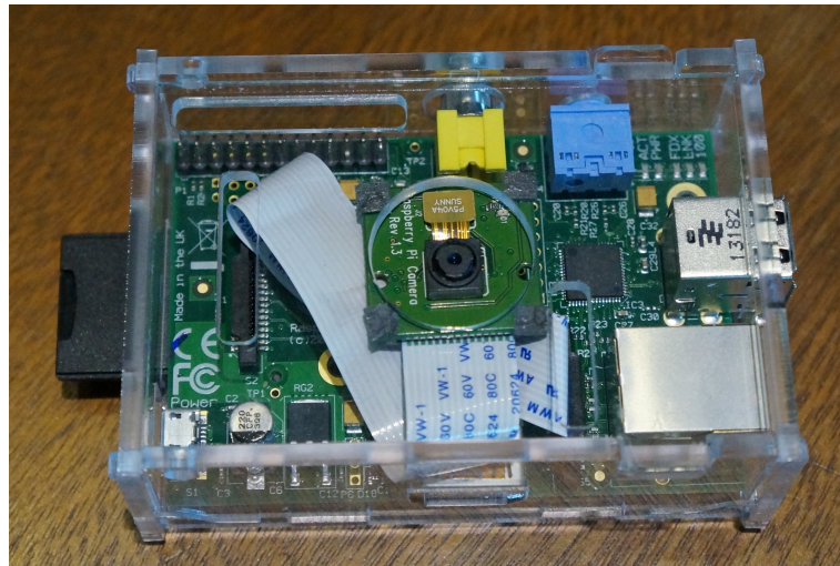
Obrázek 3.5: RPi s připojenou kamerou v praktickém obalu
