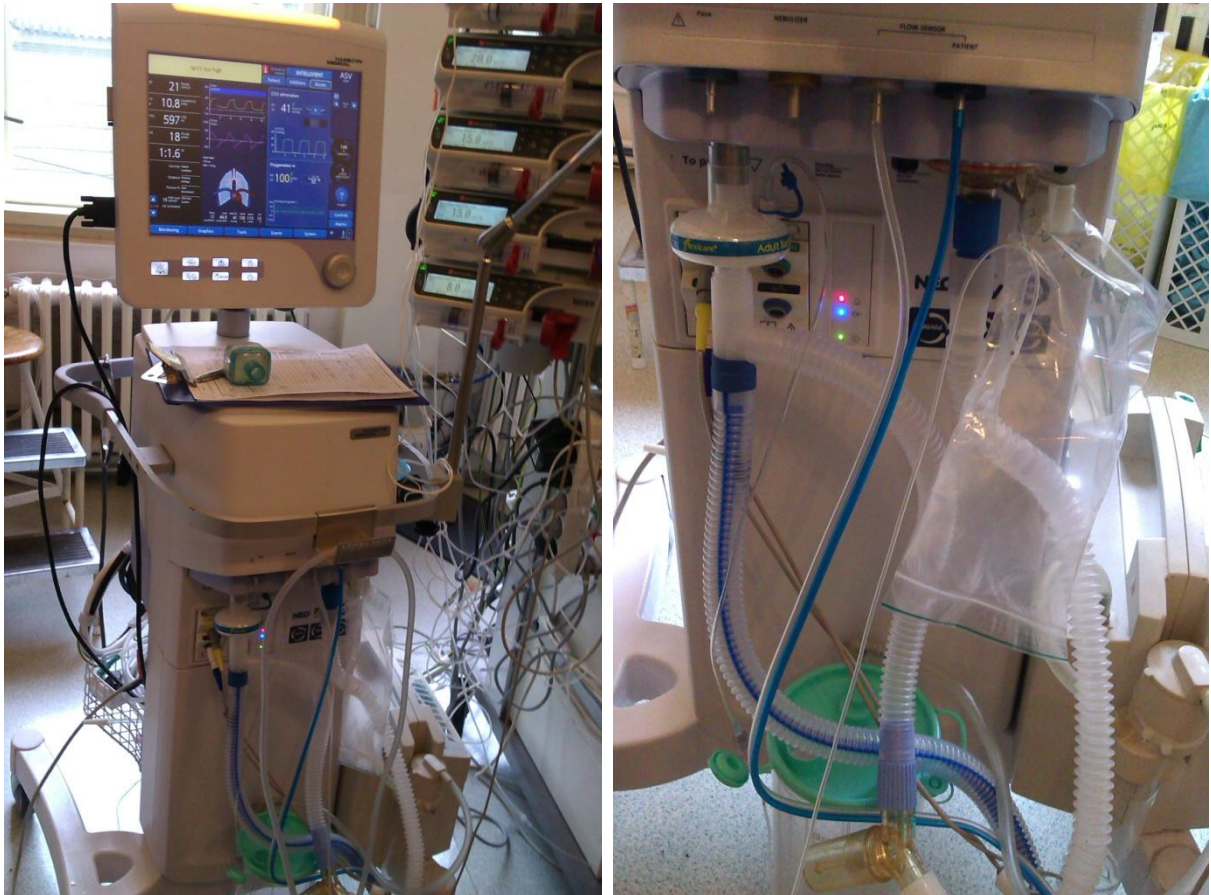
Ventilátor s připojenými odvodnými hadičkami v průběhu animálního experimentu a detail umístění zásobního vaku a připojení hadiček.
