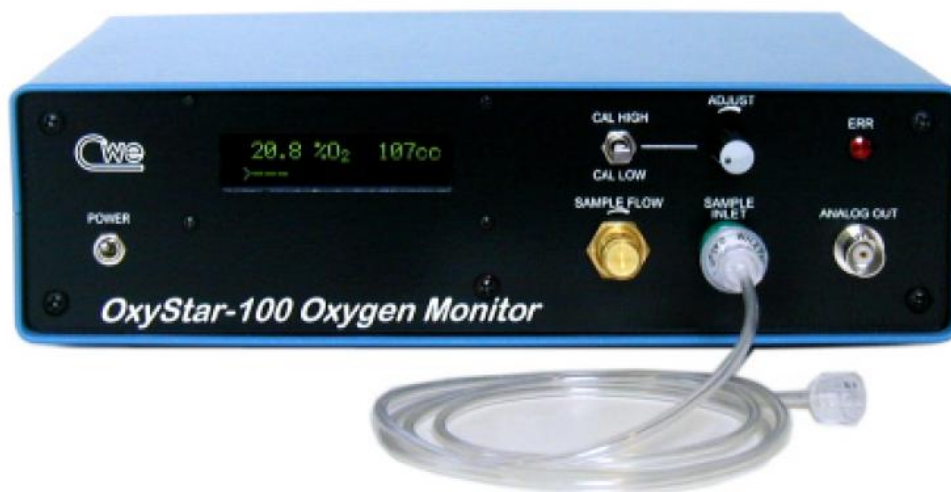
Obrázek 9: Kyslíkový senzor Oxystar-100 použitý v projektu Metabox. Na přední straně jsou patrné (zleva shora) zapínací páčka, displej, kalibrační páčka, kalibrační knoflík, ovladač průtoku, vstup měřeného plynu, chybová dioda, konektor analogového výstupu. Převzato z [28]
