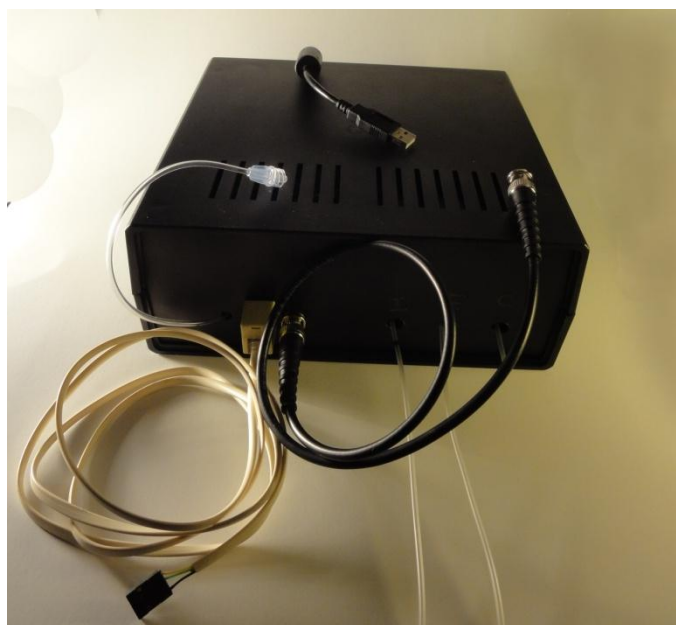
Obrázek 20: Osazený kryt pro systém Metabox s připojenými vodiči a rozvodnými hadičkami
