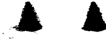
Obrázek 4.8: Detekované barevné oblasti před a po filtrování (invertováno)
