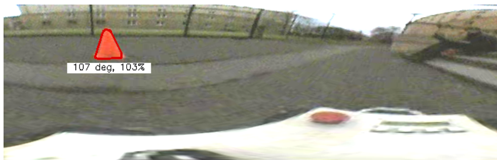
Obrázek 4.10: Detekovaný kužel a příslušný azimut (výřez)
