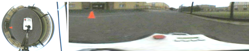
Obrázek 4.6: Původní záběr z kamery a výřez transformovaného obrázku
