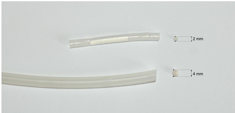
Obrázek 5.9: Kuličky a vzorky hadiček, použité k měření průměrné rychlosti proudící kapaliny
