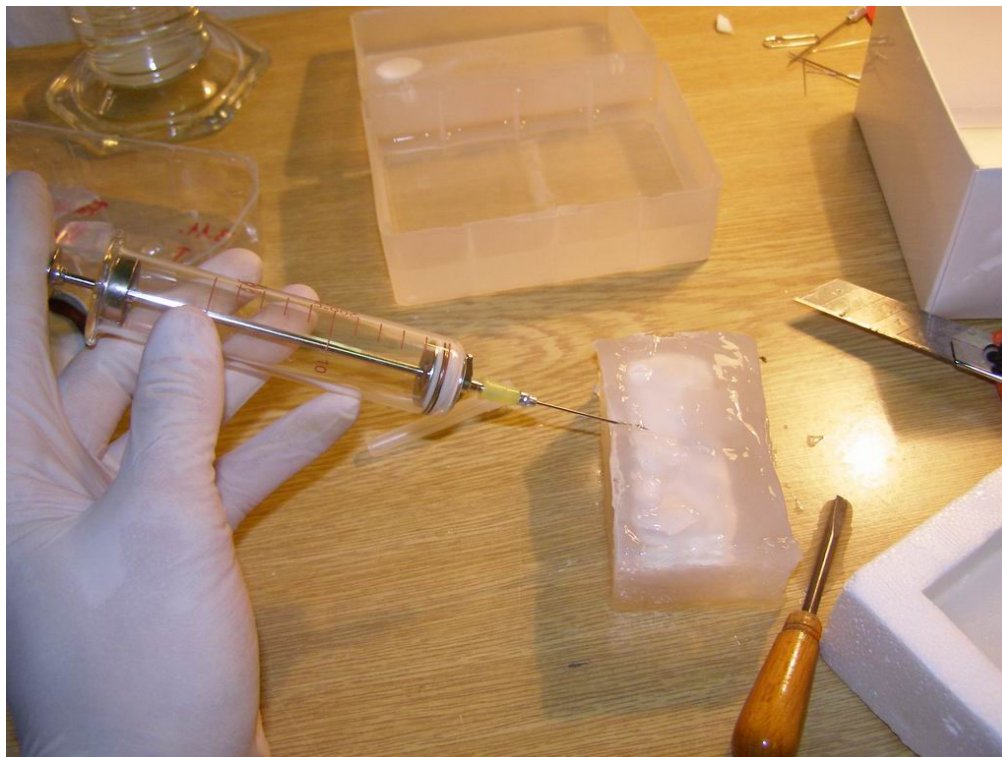
Obr.13 Vyťahovanie bubliniek injekčnou striekačkou z fantómu na ktorom sme overovali vplyv nedostatočného roztápania
