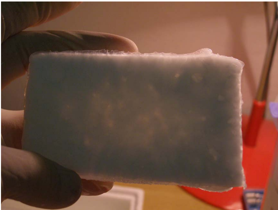
Obr. 16 Viditeľné rozdiely v tuhosti fantómu proti svetlu
