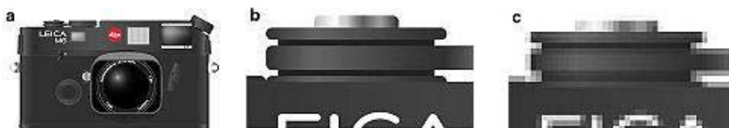
Obr. 4. Příklad efektivity při zvětšování: (a) originální obrázek; (b) zvětšeno jako vektorový obrázek; (c) zvětšeno jako rastrový obrázek. (Zdroj: Wikipedia.com)
